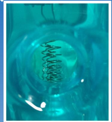
ヒーター温度を光学的に測定可能な窓を設置
